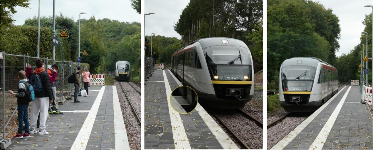
Bilder 15, 16, 17: Der Hp Auringen-Medenbach am 25. September 2022. Die Fahrgäste halten sich bei Einfahrt des Zuges sichtlich verängstigt am provisorischen Bauzaun fest. Bei der erhöhten Bahnsteigkante fällt man förmlich in den Triebwagen der Baureihe Desiro mit einer Bodenhöhe von nur 575 mm hinein (s. Lupe auf dem Foto 16). Dies ist für eine Übergangszeit tolerierbar, sofern die Fahrgäste auf dem Bahnsteig per Lautsprecherdurchsage oder auffälligen Hinweistafeln darauf hingewiesen werden.
