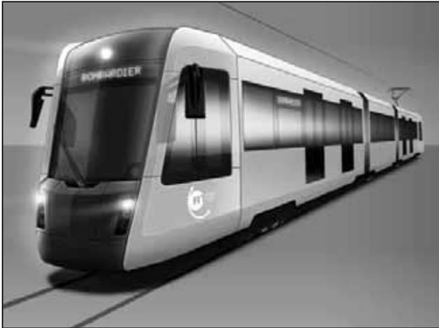
*Zwei-System-Triebwagen für die RTW.
