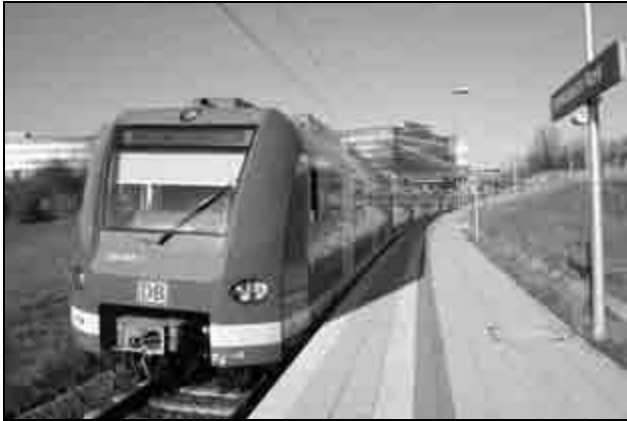
Am Haltepunkt Schwalbach Nord hat der Triebfahrzeugführer keine Sicht auf die hinteren Wagenteile (Foto: W. Staub)
